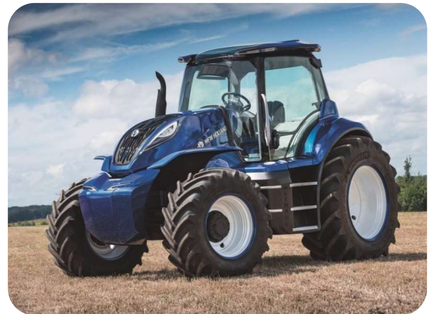
New Holland Agriculture Concept di trattore alimentato a Metano
