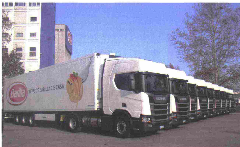
I veicoli Scania a LNG, acquistati da Nicolosi Trasporti tramite Covin, concessionaria Scania per la Sicilia, sono dotati di un motore a metano da 13 litri con una coppia da 2.000 Nm e 410 cavalli con autonomia fino a 1.100 chilometri e prestazioni paragonabili ad un diesel di pari potenza
