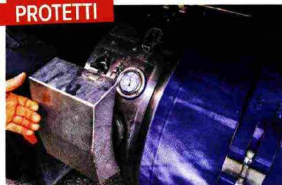
*Sganciando la copertura protettiva si accede ai bocchettoni per effettuare il rifornimento, che avviene in una manciata di minuti.*
