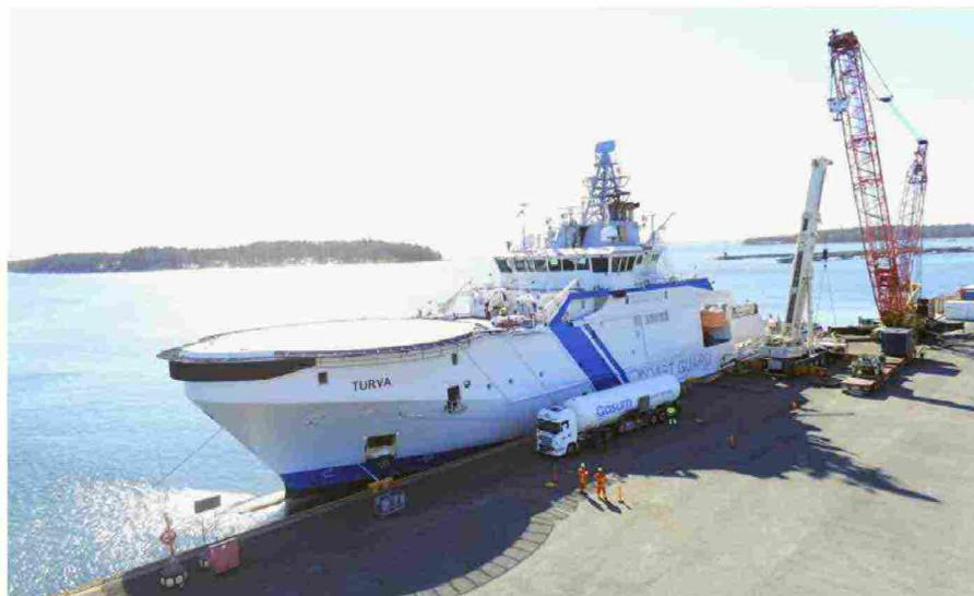
Numerose le sperimentazioni del Bio-GNL anche nel settore della navigazione. Nella foto, una motovedetta della Guardia Costiera finlandese alimentata a Bio-GNL, progetto realizzato in collaborazione con Wärtsilä e Gasum.
